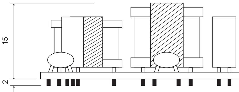
注: 此图为PCB导出尺寸, 误差为( $\pm 1$ mm)详细尺寸请根据实物为准
